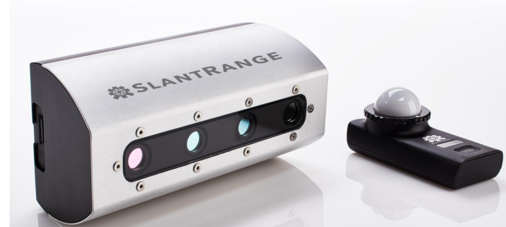
SlantRange 3p 4 Spectra 410-950nm
